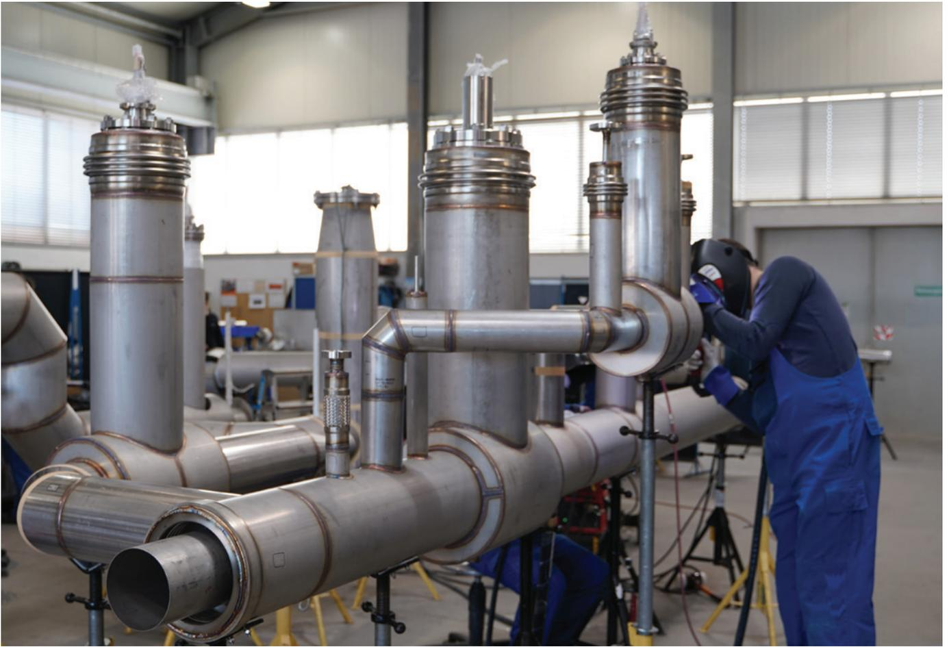
冷却され、液化したガスを貯蔵し、供給するために時間がかかりますが、その間、液体のままであるように注意する必要があります。そのためには、液化ガスを周辺環境から遮断することが必要です。そこで登場するのがニッケルです。ニッケル含有ステンレス鋼は、多くの魅力的な特性を備えています。低温でも延性、弾力性があり、液化ガス輸送の配管ネットワークに最適です。
