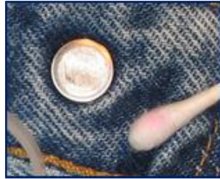
ジーンズのボタンのニッケル放出を調べる DMG 試験。 ピンクが陽性。
